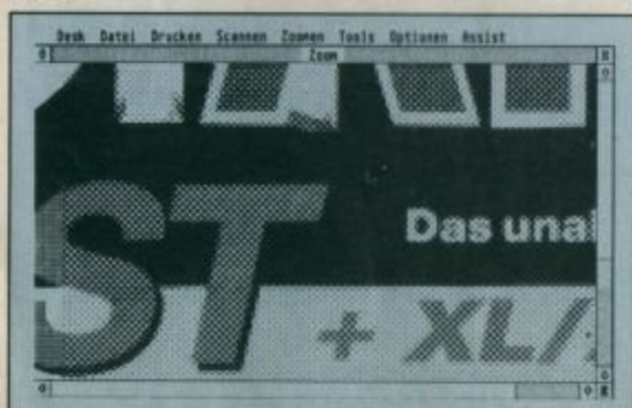
Durch Amplitudenmodulation kann bei Marvin aus dem geometrischen ein Zeitungsraster errechnet werden
